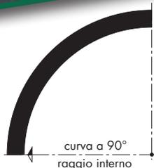
Le curve di ampio raggio si possono eseguire con mezzi cordoli
